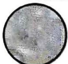
CAPA EXTERIOR OMNI ELITE II 50% Basofil® 50%Kevlar®
