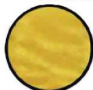
CAPA EXTERIOR Tela Nomex®100% de 7.5 / yd en color amarillo, repelente al agua.
