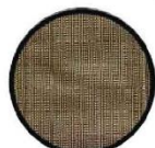
CAPA EXTERIOR OMNI ELITE II 50% Basofil® 50% Kevlar®
